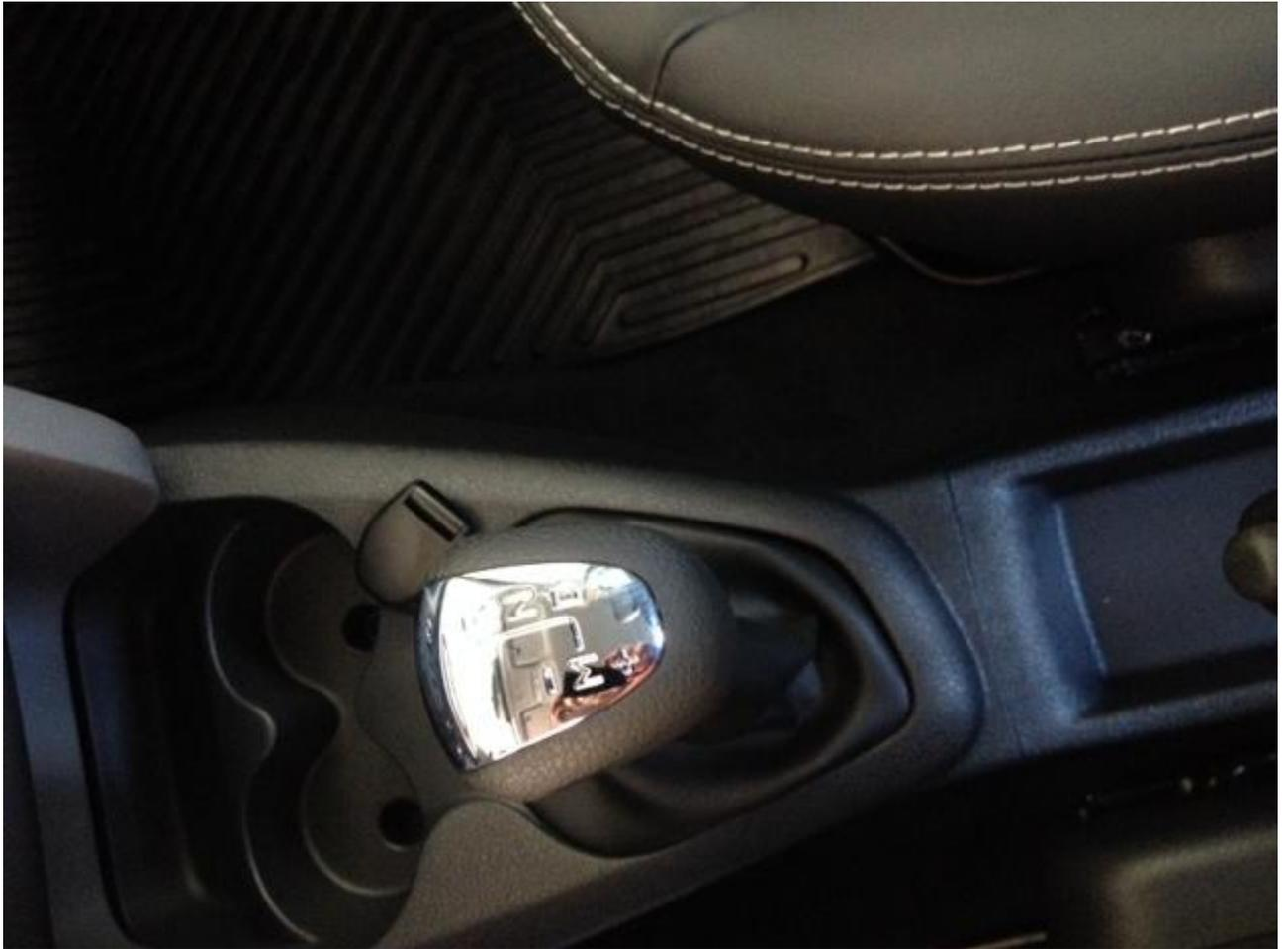
Na alavanca as posições são o R (marcha ré) que é acionada ao levar a alavanca para a direita em direção ao console central. A posição seguinte é o N (ponto morto) na posição central. Já o D (modo automático) basta posicionar para trás e a direita. No M (modo manual) é necessário que o câmbio fique posicionado a esquerda e as trocas seguem o + e – sendo que para reduzir é necessário que o condutor dê um impulso para trás e para uma marcha superior ele deverá dar um impulso para frente.
