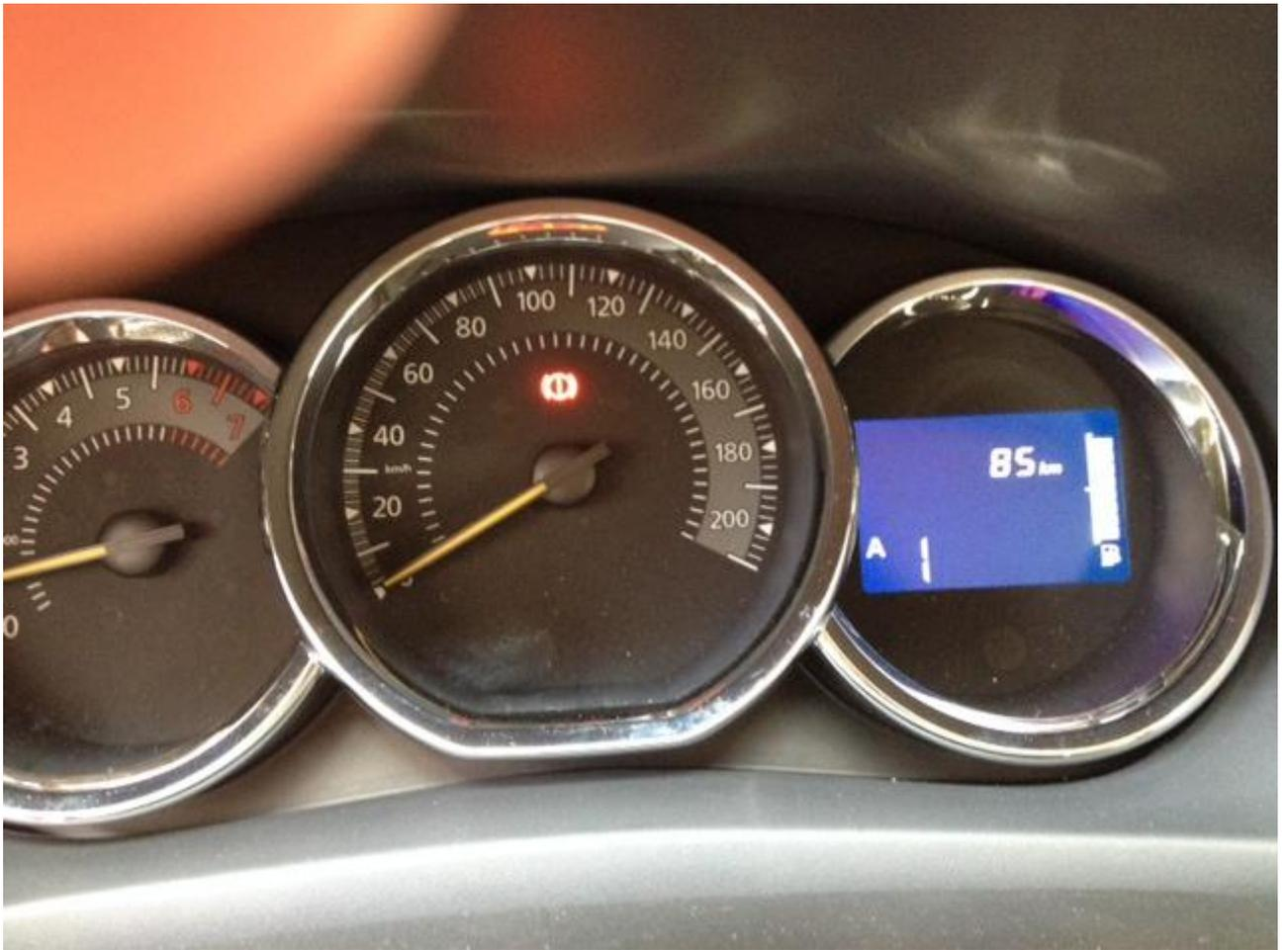
No painel de instrumentos há as indicações de qual modo está sendo usado e no modo manual aparece qual marcha está engatada. No modo automático existe a indicação de que o freio deverá ser acionado em situações de manobra ou em subidas. No caso de subidas além do indicado no painel há também o aviso sonoro caso o veículo fique por muito nas posições R ou D.
